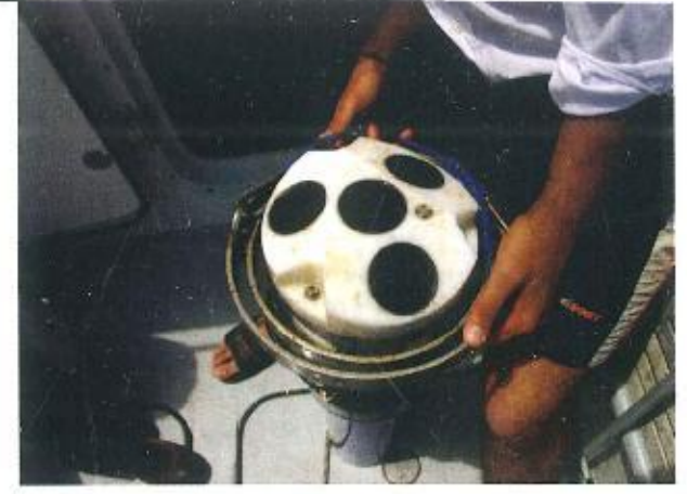
Cihazın yüzeye paralel kalmasını sağlayan halka sistemi
